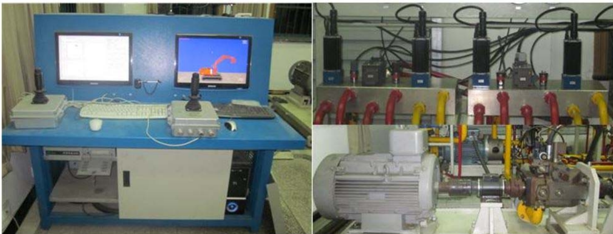
Abbildung 2-4: Abbildung des physikalischen Verhaltens eines Hydraulikbaggers durch Verknüpfung von computergestützter Simulation und realen Systemen an einem HiL-Versuchsstand [Fen-2011]
