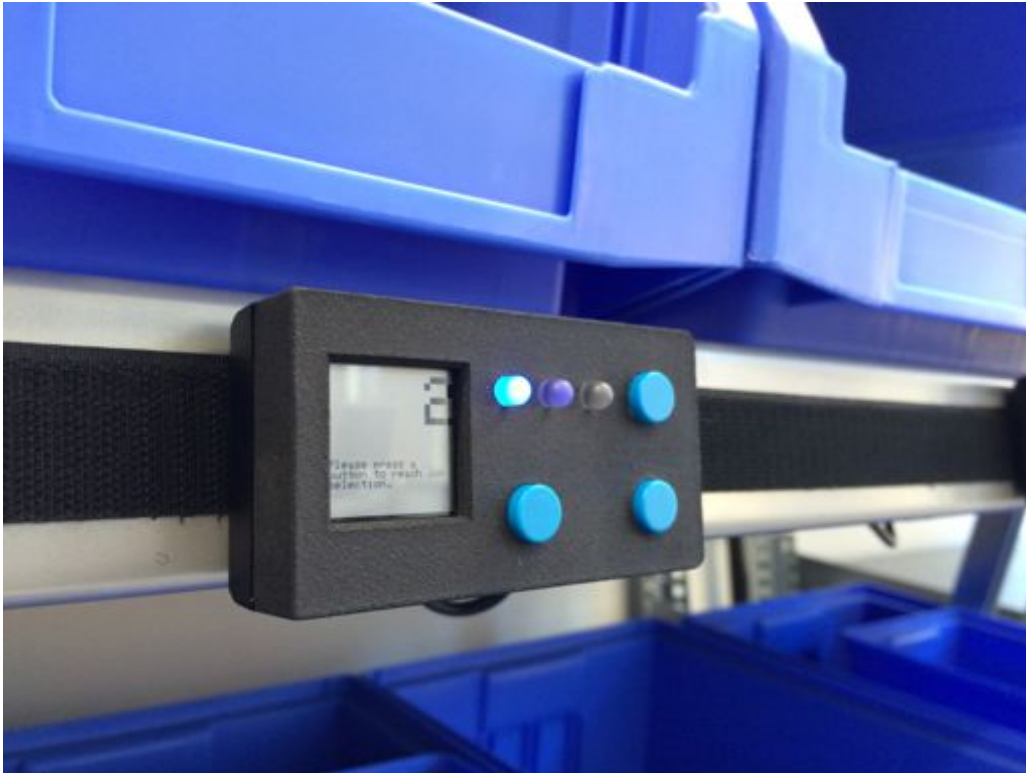
Abbildung 18: Pick-By-Local-Light-Knoten im Gehäuse am Regal montiert
