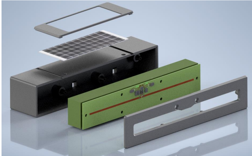
Abbildung 8-1: Explosionszeichnung des Pick-by-Tag-Transponders mit Energy Harvesting über Solar
