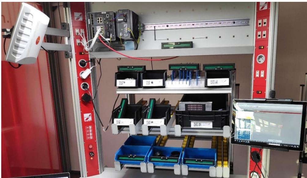
Abbildung 8-2: Integration des PbT Systems in den Montagearbeitsplatz bei einem Anwendungspartner mit RFID-Reader (links), flexiblen Tags in/auf Boxen oder Bauteilen (mitte) und Steuerung per Tablet und ERP-Daten (rechts)
